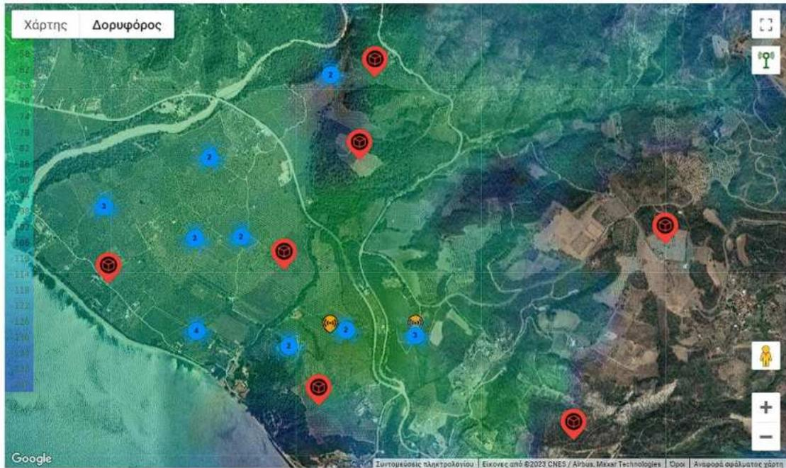
Σημεία τοποθέτησης συσκευών στους ελαιώνες των Ροβιών. Οι χρωματισμένες περιοχές απεικονίζουν το σήμα LoRa που καλύπτει τους ελαιώνες και επιτρέπει στις συσκευές να συνδέονται ασύρματα στο σύστημα.
